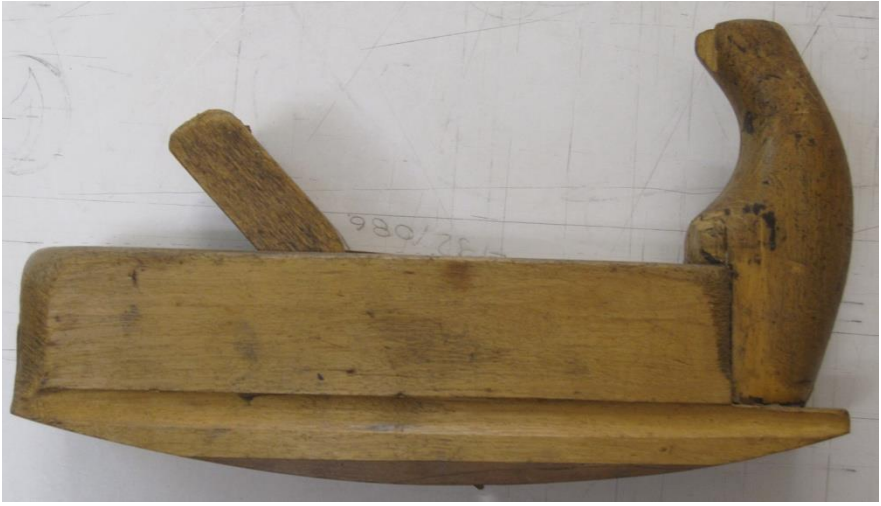
Ροκάνι για κοίλα ροκανίσματα
