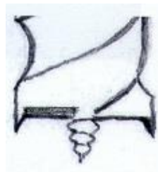
Αρίδα. Στην αριστερή πλευρά φαίνεται το καλέμι που ακονίσαμε.
