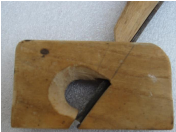
Γκινόσο μίνι: ροκανίζει και χωράει όπου δεν μπορούν να δουλέψουν τα μεγάλα
