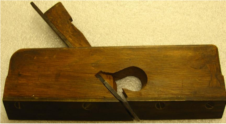
Γκινόσο λοξό με μεταλλικό πέλμα: με τη λοξό μαχαίρι ροκανίζει ηπιότερα
