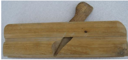
Τσιμπουκάκι: Τσιμπουκάκια υπάρχουν πολλών ειδών με διάφορα μαχαίρια, που κάνουν στρογγύλια λούκια τρίγωνα κλπ.
