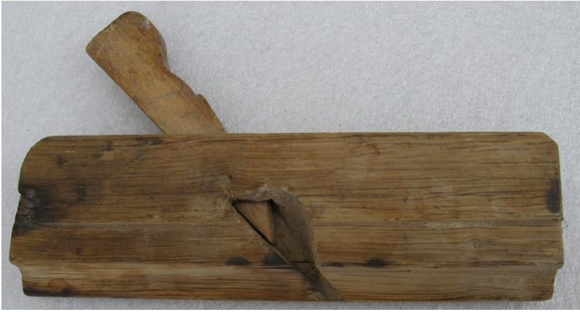
Κορδόνι σκέτο στρογγύλι. Δουλεύεται με δύο χέρια.
