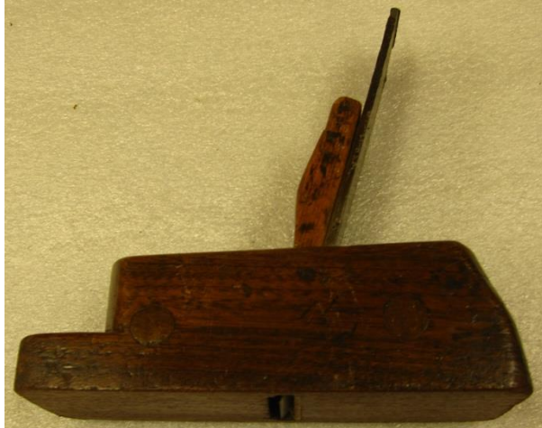
Κόχα: κοχάρει, γρατζουνάει, προετοιμάζει τις επιφάνειες που πρόκειται να κολληθούν με καπλαμά.
