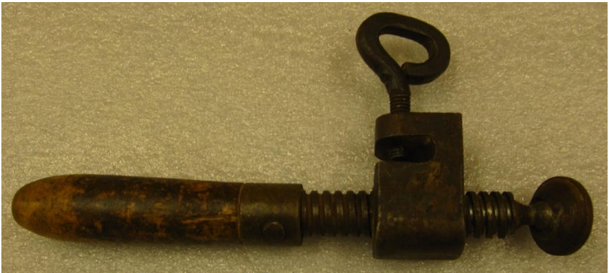
Σφικτήρας για ειδικές περιπτώσεις. Γωνίες στραβά κλπ.
