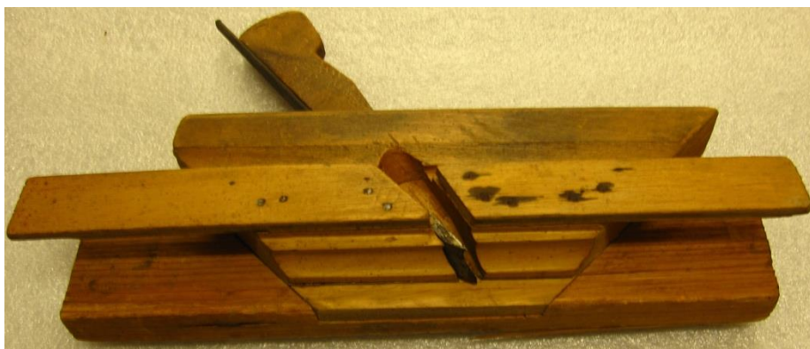
Κορδόνι σε σχήμα αμύγδαλο: δουλεύεται από την αριστερή πλευρά του κατεργαζόμενου ξύλου και πιάνεται με δύο χέρια.
