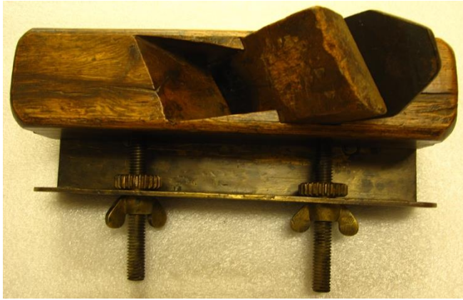
Ταμπλαρόκανο με λοξή λάμα και οδηγό μεταλλικό.
