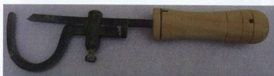
Σκαρπέλο-παχύμετρο-ξεχοντρηστήρας χρησιμοποιείται στο χειρότορνο.
