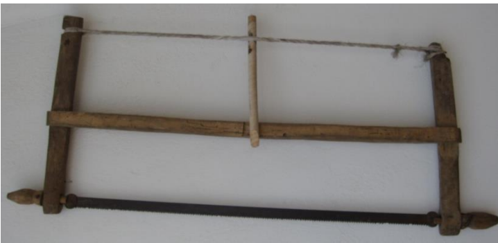
Κουραστάρι: με τις χειρολαβές που φαίνονται στις άκρες μπορούμε να στρίψουμε τη λάμα για να σχίσουμε μακριά ξύλα. Το τέντωμα της ταινίας ρυθμίζεται από τον εντατήρα.
