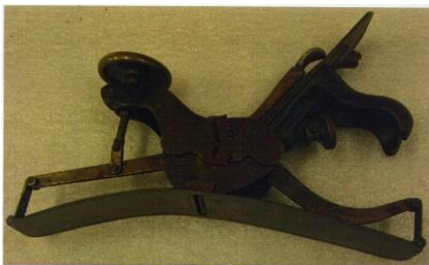
Ροκάνι ειδικό να ροκανίζει διάφορες κούρμπες. Φαίνονται οι ρυθμιστές του.
