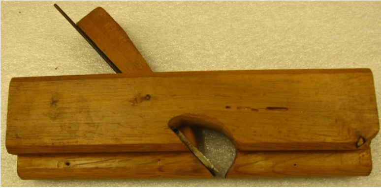
Λούκι: με το λούκι κάνουμε λουκιές σύμφωνα με το φάρδος του εργαλείου. Δουλεύεται με ένα χέρι.
