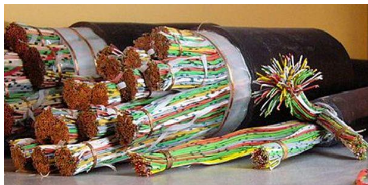
Εικόνα 3.11 Καλώδια σύνδεσης κύριου καταναμητή με αστικό κέντρο (6, 100 και 2.000 ζευγών καλωδίων).
