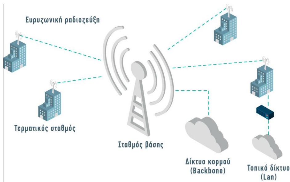
Εικόνα 3.23 Σύστημα σταθερής ασύρματης πρόσβασης ( Fixed Wireless Access ).
